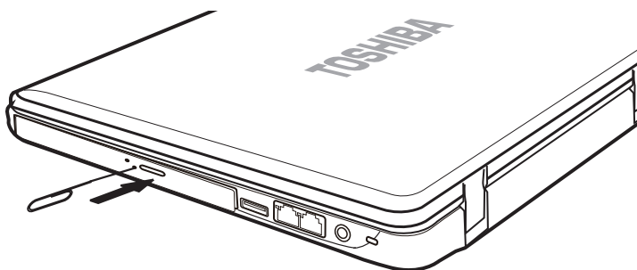
Obrázek 4-4 Ruční otevření zásuvky pomocí otvoru pro vysunutí
