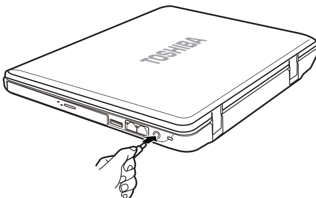
Obrázek 3-2 Připojení adaptéru k počítači
