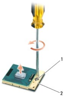
1 ZIF-socket cam screw 2 ZIF socket
